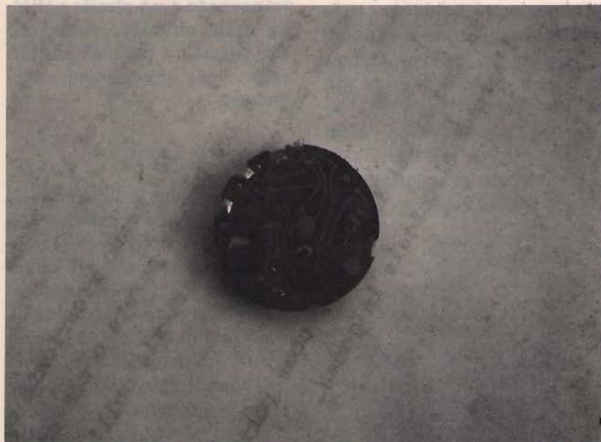
Figura 6. Aspetto esterno del modulo interno di un comune orologio digitale.
