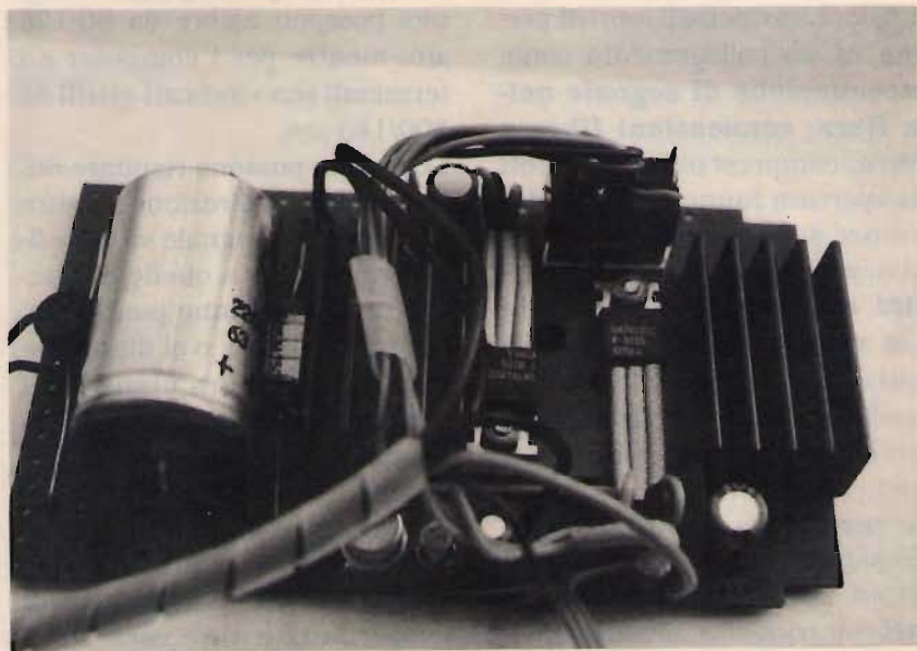
Il caricabatterie programmabile a montaggio ultimato: si è scelto come supporto una basetta preforata per prototipi.
